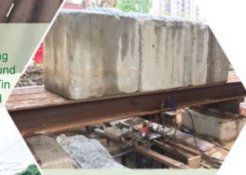
泥土壓力測試 Plate Load Test
